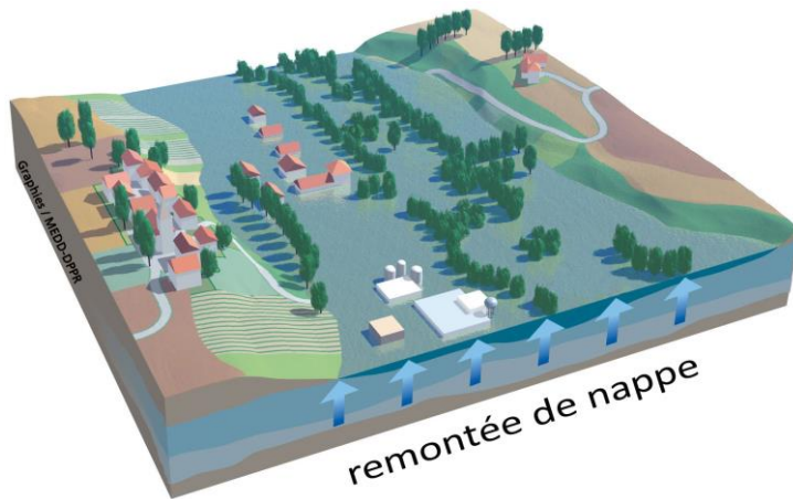
Inondations par remontée de nappes, source : BRGM
